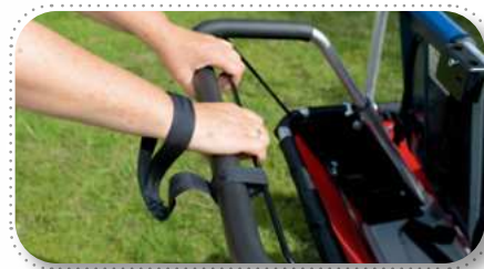
Schleife, die den Bremsbügel fest am Handgriff hält.
